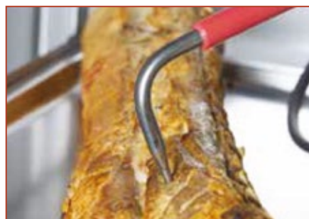
Temperatuurmeter met 3-punts multisensor, standaard. Temperatuurmeter met 6-punts multisensor, als optie verkrijgbaar.
